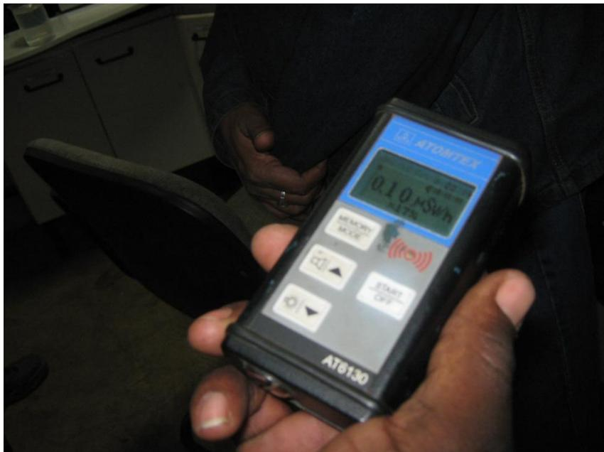
**Figure 4. Appareil de contrôle de radioactivité des minerais réceptionnés.**
