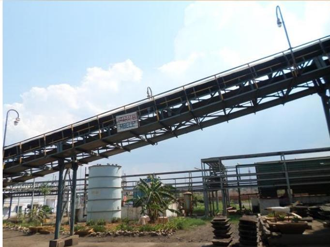
**Figure 13.**Transporteur permettant la réduction des poussières générées par les camions au chargement.
