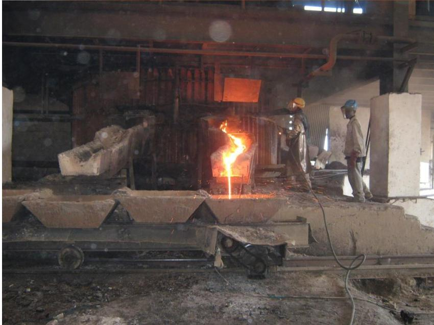
Figure 10. Coulée de cuivre dans la section pyro.
