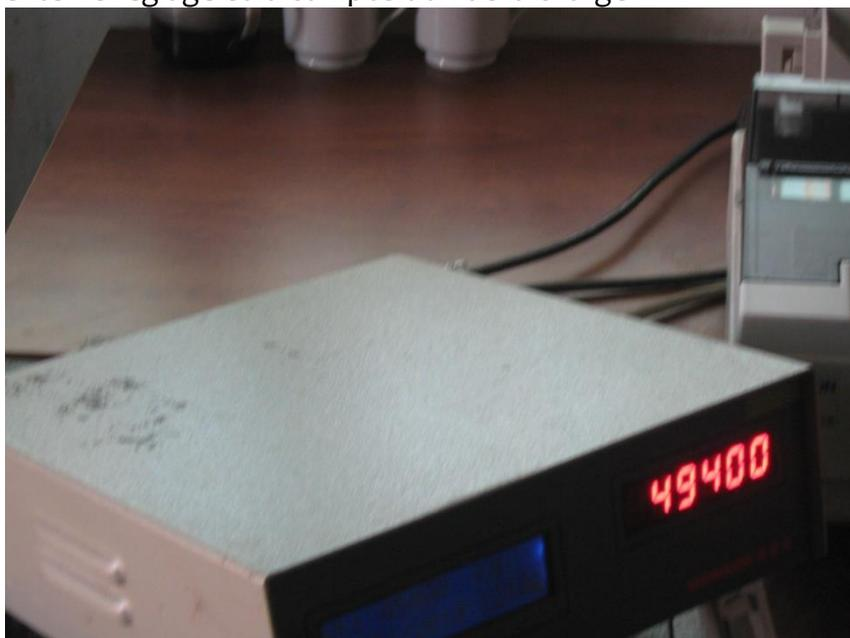
**Figure 3.**Indication numérique du tonnage d'un camion d'approvisionnement sur le pont-bascule.
