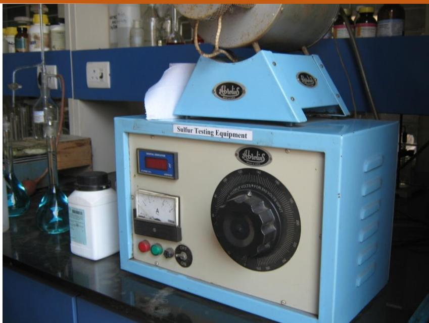
Figure 2 : Appareil de mesure du taux de soufre dans les approvisionnements.
