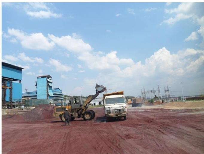
**Figure 19. Chargement de la scorie dans un camion pour le recyclage.**
